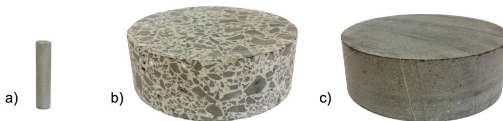
Rys. 2. Próbkki stosowane do badania przepuszczalności: a) zaczynu 10/50 mm, b) betonu 50/150 mm, c) bazaltu 50/150 mm
